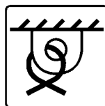
Fig. - 61 Mærkater til fastsurringspunkter
