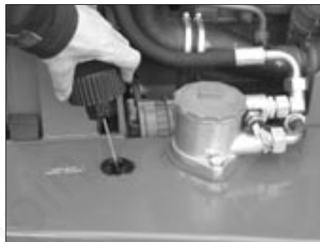
Fig. - 65 Reducering af resttrykket
